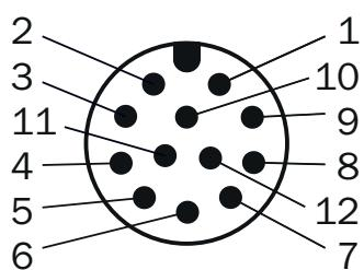
vue connecteur d'appareil M12 sur le codeur
