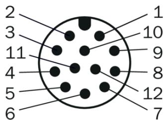
vue connecteur d'appareil M12 sur le codeur
