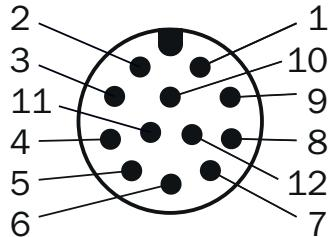
vue connecteur d'appareil M12 sur le codeur
