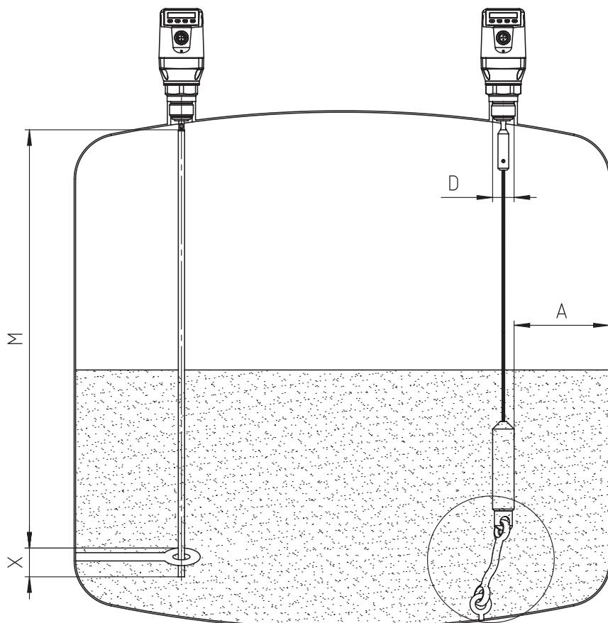
**Sonde à câble dans le réceptacle métallique**
