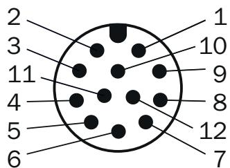
vue connecteur d'appareil M12 sur le codeur
