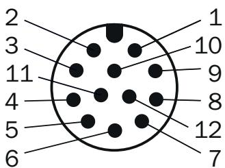
vue connecteur d'appareil M12 sur le codeur
