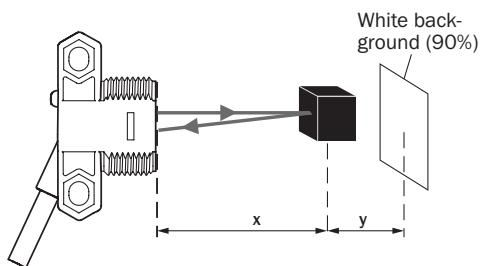
ZTB18-xxxxx-D02:  $x = 47 \text{ mm} / y = 4 \text{ mm}$
