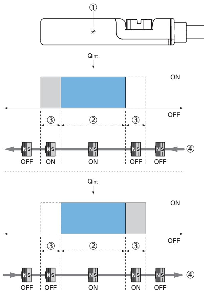
Remarque : le boîtier du capteur peut différer ; la représentation correspond à la fonction de sortie « contact NO » ; distance de dépassement = largeur du point de commutation + hystérésis
