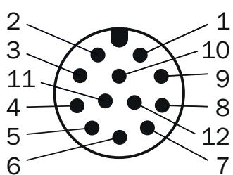
vue connecteur d'appareil M12 sur le codeur
