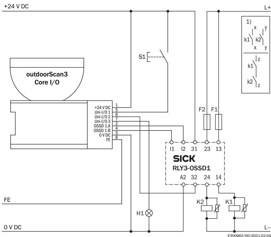
① Circuits de sortie : ces contacts doivent être intégrés dans la commande de manière à ce que lorsque le circuit de sortie est ouvert, la situation dangereuse prenne fin. Pour les catégories 4 et 3, cette intégration doit s'effectuer en double canal (voies x et y). L'insertion en mono canal dans la commande (voie z) n'est possible que pour les commandes en mono canal et après avoir pris en compte l'analyse des risques.
