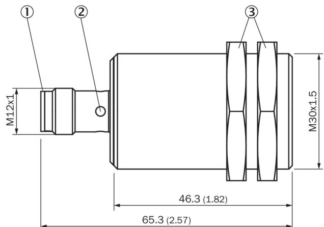
③ Écrous de fixation (2 x) ; SW 36, acier inoxydable V4A
