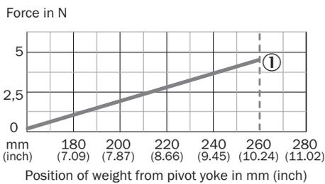
① force d'appui maximale en fonction de la position de montage du contre-poids (260 mm)
