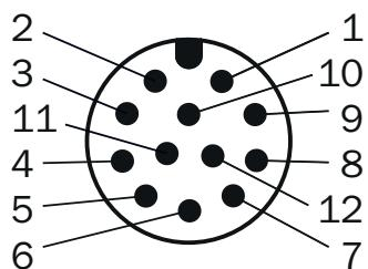
vue connecteur d'appareil M12 sur le codeur
