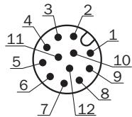
Câble de raccordement avec connecteur mâle ou connecteur mâle M12, 12 pôles, codage A
