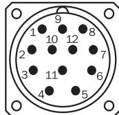
vue du connecteur d'appareil M23 sur le câble/boîtier
