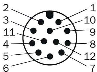
vue connecteur d'appareil M12 sur le codeur
