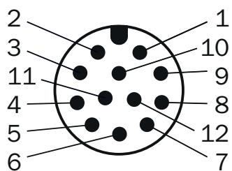
vue connecteur d'appareil M12 sur le codeur
