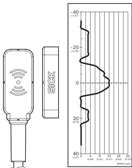
Distance d'activation sécurisée Sao 9 mm. Respecter les zones de bord lors d'un rapprochement parallèle : si l'actionneur se déplace latéralement par rapport à la surface du capteur, respecter une distance minimale de 4 mm (standard). Ceci empêche le déclenchement précoce causé par les zones d'approche latérales.
