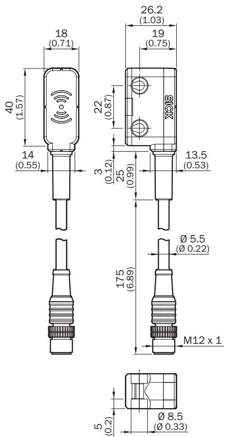
Plage de réponse Actionneur « plat / mini », surface de capteur active frontale
