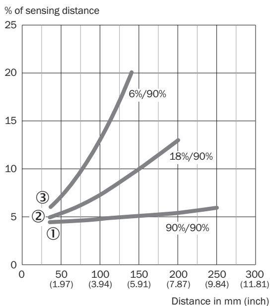
① objet avec un coefficient de réflexion diffuse de 90 % (par rapport au blanc standard selon DIN 5033)
