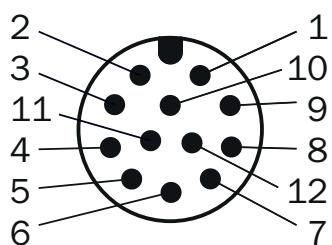
vue connecteur d'appareil M12 sur le codeur
