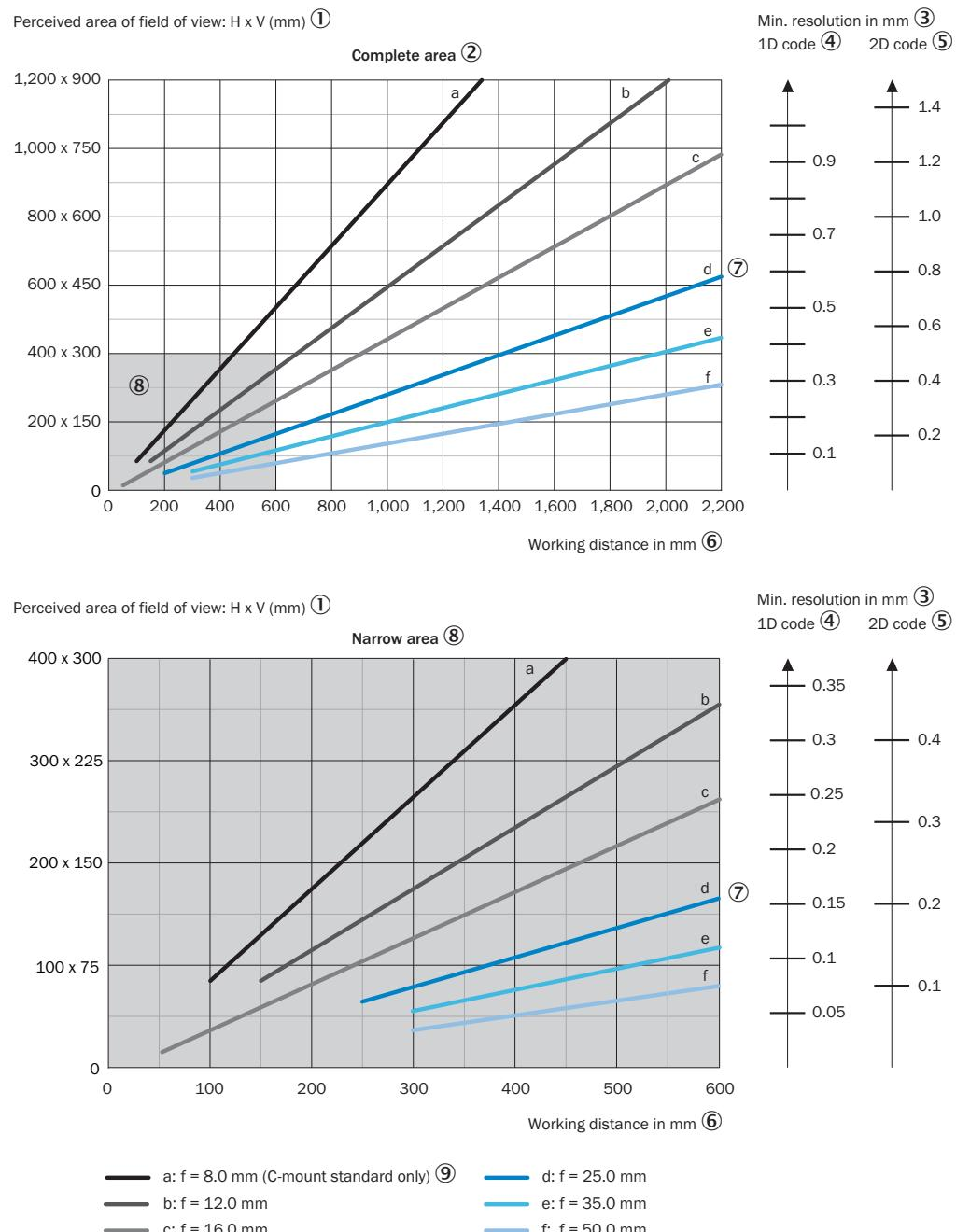
Pour des objectifs S-Mount et C-Mount standard, des bagues d'écartement sont nécessaires pour des distances de travail inférieures à 10 fois la distance focale.
