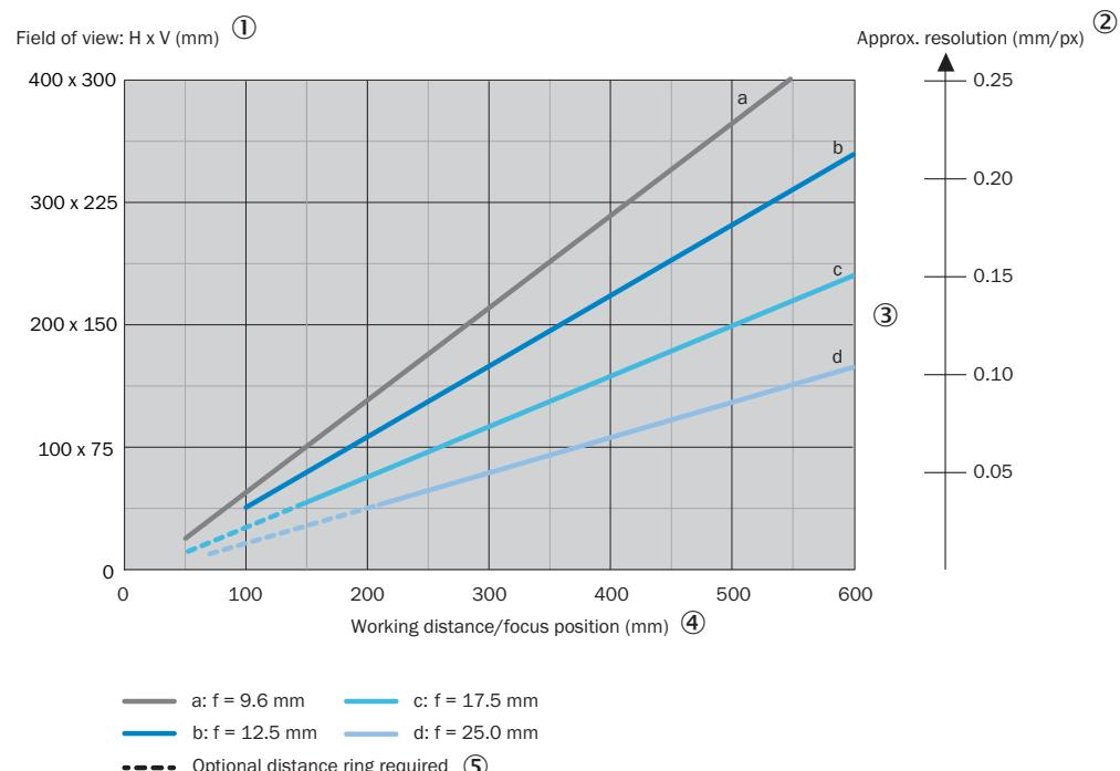
Pour des objectifs S-Mount et C-Mount standard, des bagues d'écartement sont nécessaires pour des distances de travail inférieures à 10 fois la distance focale.
