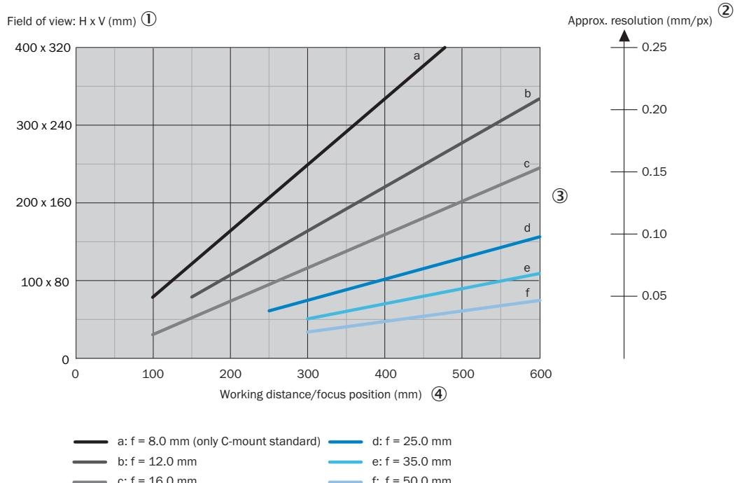
Pour des objectifs S-Mount et C-Mount standard, des bagues d'écartement sont nécessaires pour des distances de travail inférieures à 10 fois la distance focale.
