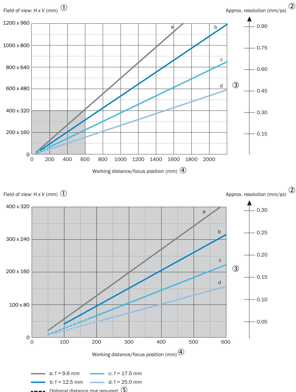
Pour des objectifs S-Mount et C-Mount standard, des bagues d'écartement sont nécessaires pour des distances de travail inférieures à 10 fois la distance focale.
