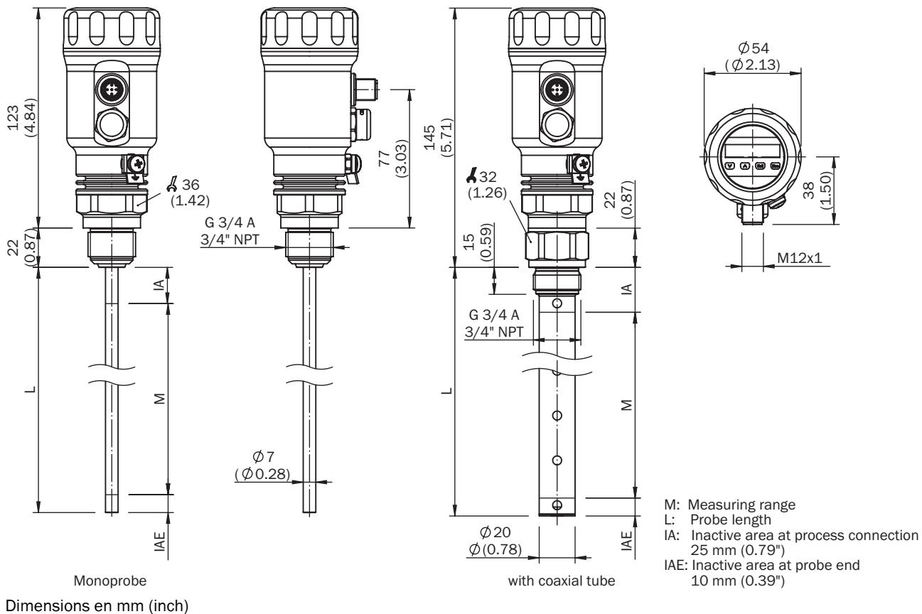
Mode de raccordement Connecteur enfichable M12, 8 pôles
