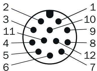
vue connecteur d'appareil M12 sur le codeur
