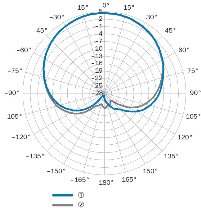
gain de l'antenne mesuré en dBic à 868,5 MHz, RHCP (polarisation circulaire avec rotation à droite)
