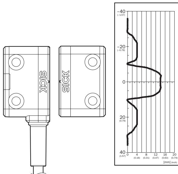
Distance d'activation sécurisée  $S_{ao}$  10 mm. Respecter les zones de bord lors d'un rapprochement parallèle : si l'actionneur se déplace latéralement par rapport à la surface du capteur, respecter une distance minimale de 6 mm (standard). Ceci empêche le déclenchement précoce causé par les zones d'approche latérales.
