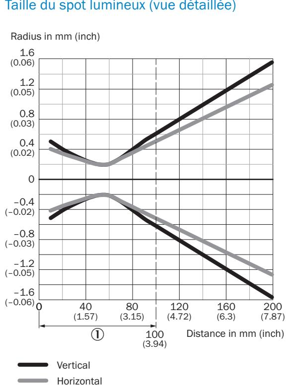
① distance minimale entre le capteur et le réflecteur
