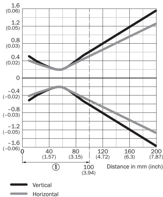
① distance minimale entre le capteur et le réflecteur
