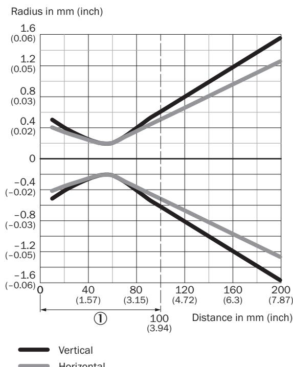
① distance minimale entre le capteur et le réflecteur
