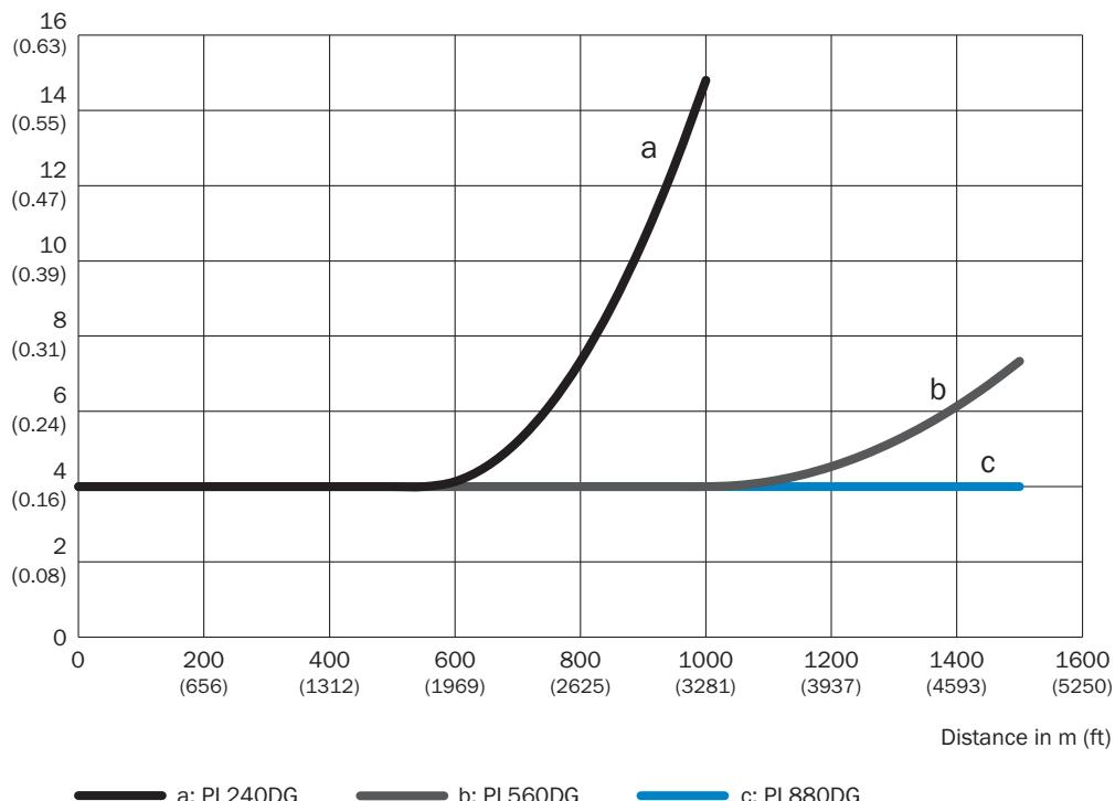
Exactitude de mesure Typiquement DL1000, axe des x : distance, axe des y : exactitude de mesure typ.
