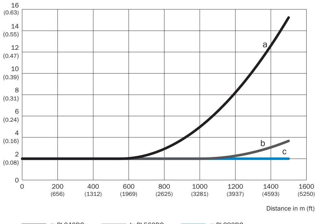
Précision de répétition DL1000 pour différents types de réflecteurs, pour une durée de cycle de mesure de 1 ms
