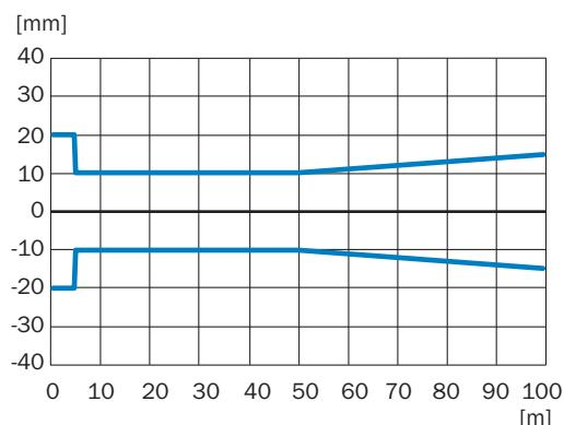
Exactitude de mesure Typiquement DL1000, axe des x : distance, axe des y : exactitude de mesure typ.
