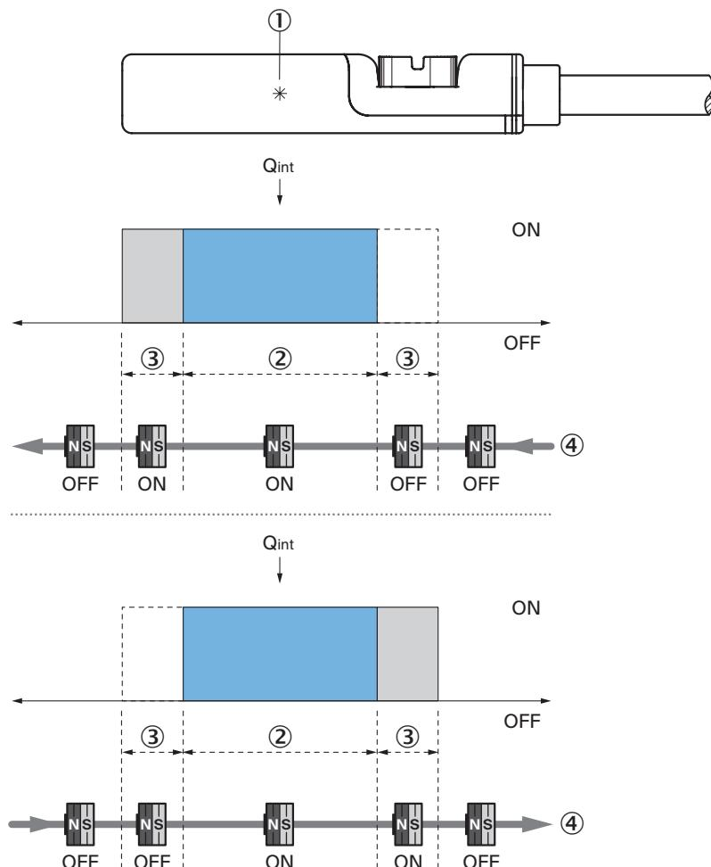
Remarque : le boîtier du capteur peut différer ; la représentation correspond à la fonction de sortie « contact NO » ; distance de dépassement = largeur du point de commutation + hystérésis
