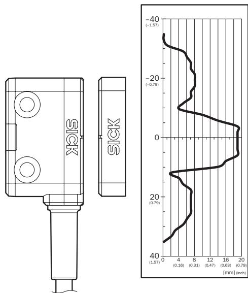
Distance d'activation sécurisée Sao 14 mm. Respecter les zones de bord lors d'un rapprochement parallèle : si l'actionneur se déplace latéralement par rapport à la surface du capteur, respecter une distance minimale de 10 mm (standard). Ceci empêche le déclenchement précoce causé par les zones d'approche latérales.
