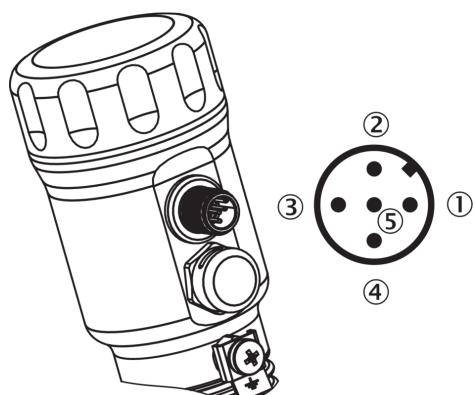
① L<sup>+</sup> : tension d'alimentation, marron② Q<sub>A</sub> : sortie analogique en courant / tension, blanc
