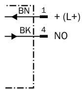
Schéma de raccordement Cd-306
