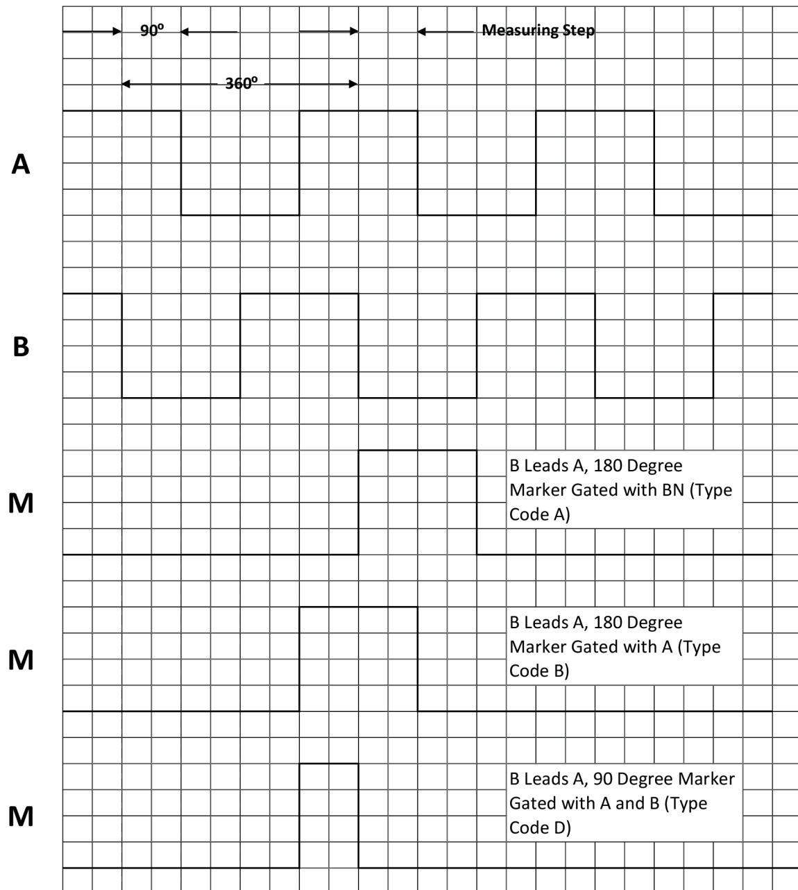
Dans le sens horaire avec vue sur l'arbre de codeur dans la direction « A », voir plan coté.
