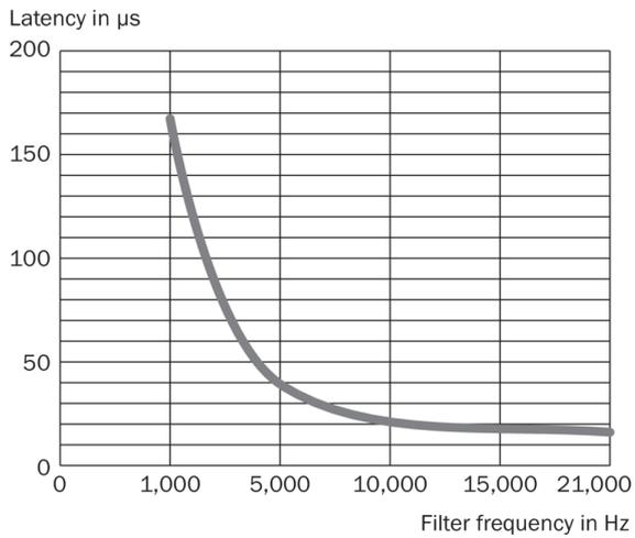
Fréquences de filtre réglables 21 kHz, 15 kHz, 10 kHz, 5 kHz et 1 kHz - réglage par défaut 21 kHz
