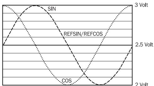
évolution du signal pour une rotation de l'axe dans le sens horaire ,vue dans la direction « A » (voir plan côté)
