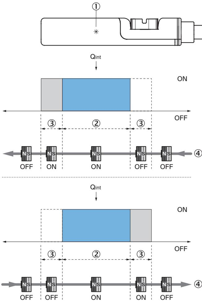
Remarque : le boîtier du capteur peut différer ; la représentation correspond à la fonction de sortie « contact NO » ; distance de dépassement = largeur du point de commutation + hystérésis
