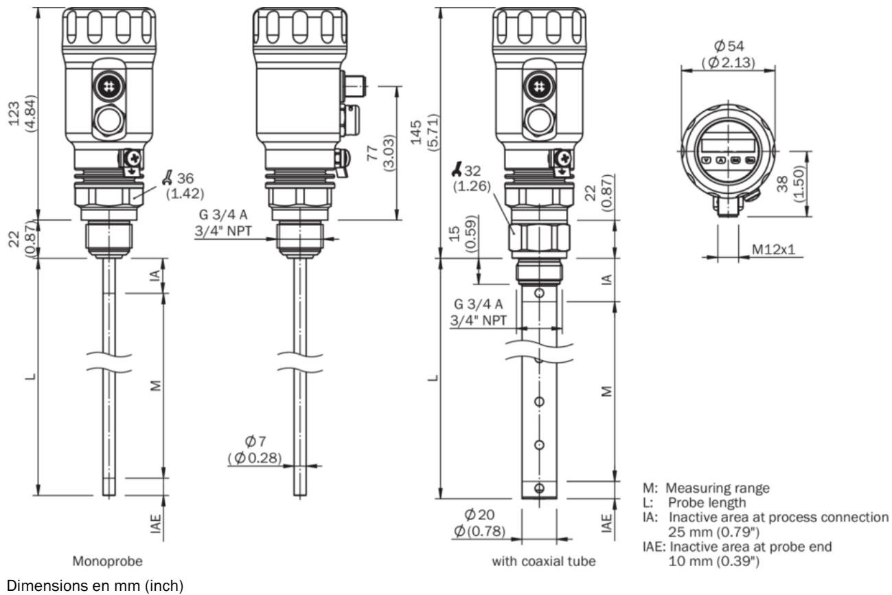
Mode de raccordement Connecteur M12, 5 pôles
