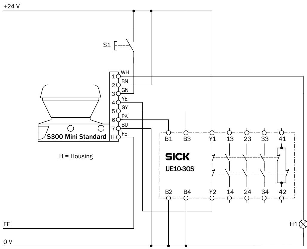
Exemple de câblage S300 Mini Standard avec fonction de réarmement et contrôle des contacteurs commandés
