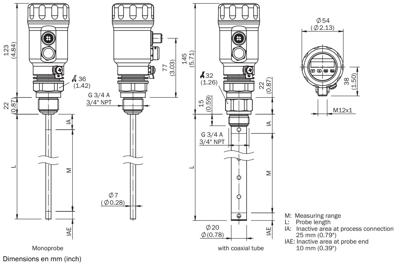
Mode de raccordement Connecteur M12, 5 pôles
