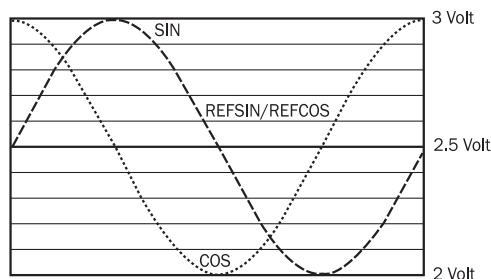
évolution du signal pour une rotation de l'axe dans le sens horaire ,vue dans la direction « A » (voir plan côté)
