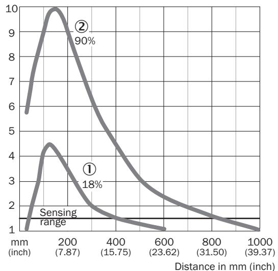
① Distance de commutation sur gris, coefficient de réflexion diffuse 18 %
