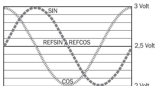
Diagramme Signalspezifikation des Prozesskanals
