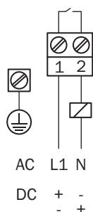
Anschlussart LFV300 Kontaktloser Schalter - Elektronikeinsatz
