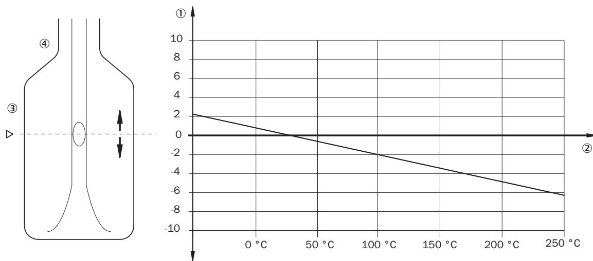
① Verschiebung des Schaltpunktes in mm (in)
