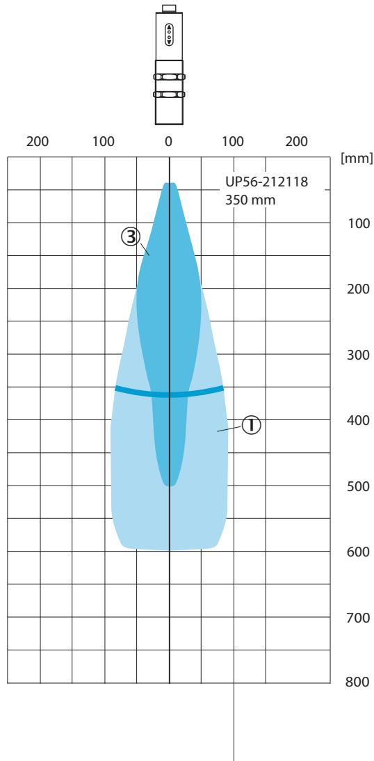
Befinden sich die oben genannten Punkte im Abstrahlkegel, ist eine zuverlässige Erkennung gewährleistet
